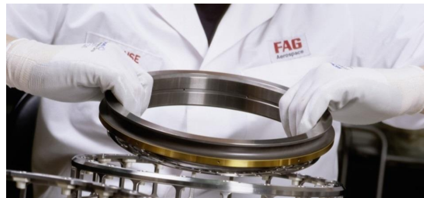
Montáž leteckých ložísk vo Schweinfurte, Nemecko
