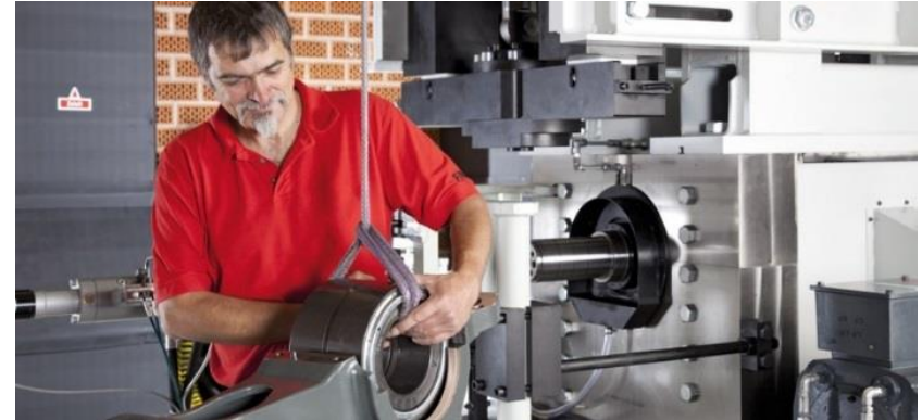
Schaeffler testovacie zariadenie pre koľajové nápravové ložiská, Schweinfurt (Nemecko)
